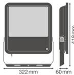
Scheda tecnica Ledvance Proiettore LED Photocell GEN 3 Nero 165W 20000lm 100D - 840 Bianco Freddo | IP65 - Sensore di luce - Simmetrico
